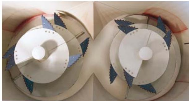
Турбокрыло на турбо-шнеке способствует эффективному смешиванию и обеспечивает равномерную и быструю раздачу.
