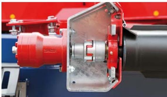
Сцепление между приводным двигателем и валиком обеспечивает плавный ход и долгий срок службы.
