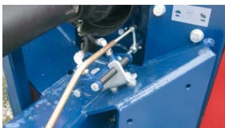
Гидравлический переключатель коробки передач.
