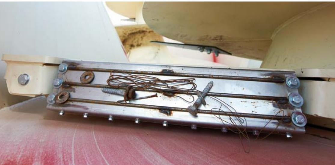
Высокомощный магнит на турбо-шнеке.
