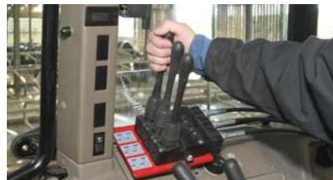
Опция: механическое управление через рычаги вкл. управление коробкой передач и ручное регулирование скорости разгрузочного транспортера (делитель потока).
